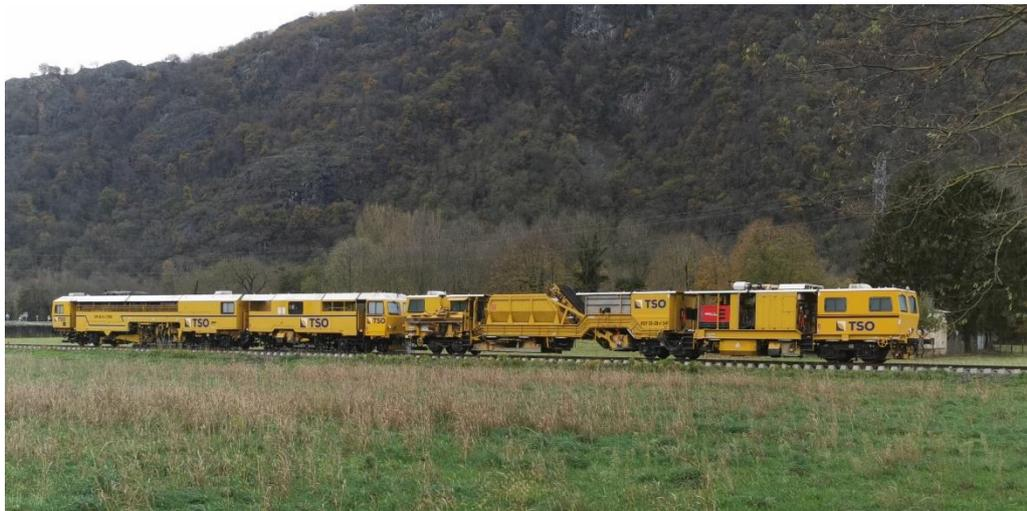
La bourreuse, train pour la mise en place de la voie ferrée est sur place, premiers essais de roulage au mois de mars pour une mise en service commerciale fin 2025. Un retour attendu pour le développement économique et touristique de notre vallée.
